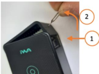
Utilisez l'outil de démontage, insérez dans le trou, et démontez le capot.
