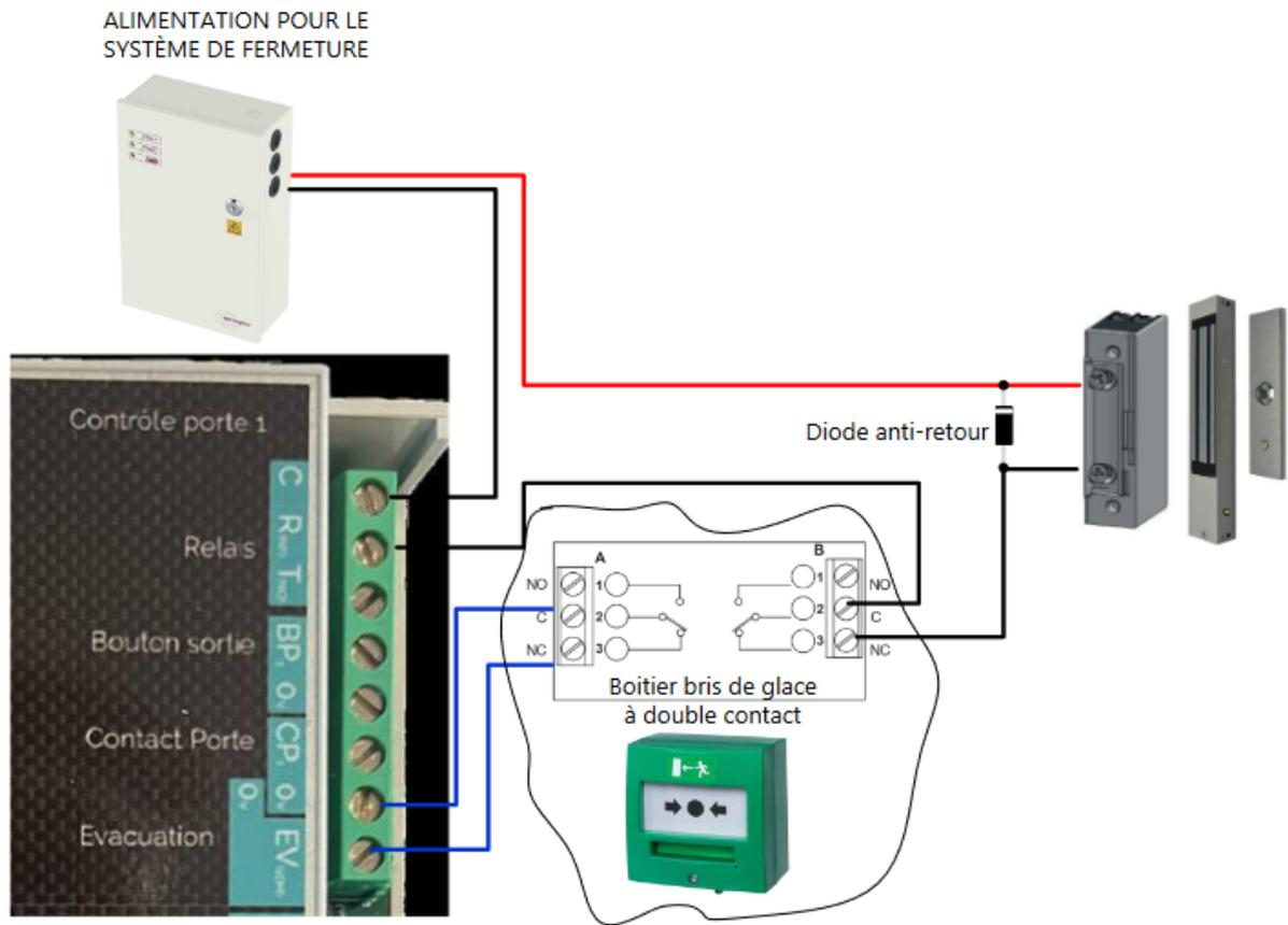
Afin d'éviter tous dysfonctionnements aléatoires qui viendraient perturber la bonne utilisation due à des courants de retour, il est impératif d'utiliser et de raccorder des diodes anti-retour livrées avec le système de fermeture.
