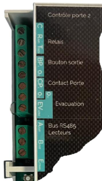
Quand la ligne de télécommande est configurée en émission, il faut laisser le strap (fournis et placé par défaut) sur les bornes « 0v-EVx(DM) ». L'accès est autorisé quand la ligne est alimentée (contact relais utilisé CT).
