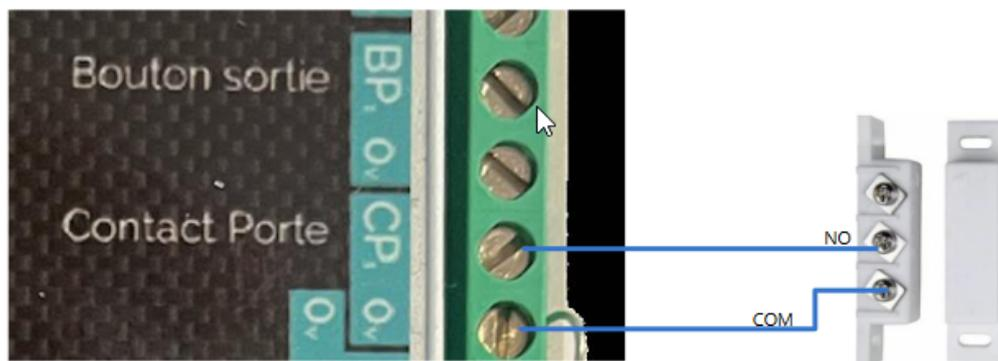
Par défaut, l'entrée est de type « NO », il est possible d'utiliser des contacts de porte de type « NF ». Il faudra alors reconfigurer l'entrée correspondante sur le logiciel (Paramètres contrôleur de porte dans la rubrique Porte)
