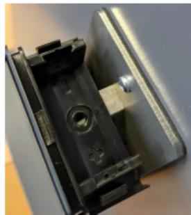
Remplacez et serrez la vis de fixation Torx.
