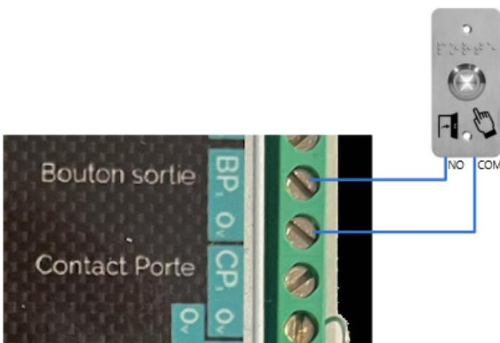
Par défaut, l'entrée est de type « NO », il est possible d'utiliser des contacts de porte de type « NF ». Il faudra alors reconfigurer l'entrée correspondante sur le logiciel (Paramètres contrôleur de porte dans la rubrique Porte).
