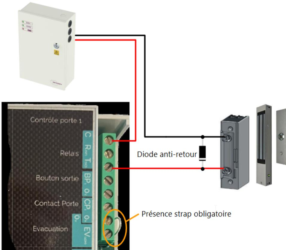
Afin d'éviter tous dysfonctionnements aléatoires qui viendraient perturber la bonne utilisation due à des courants de retour, il est impératif d'utiliser et de raccorder des diodes anti-retour livrées avec le système de fermeture.
